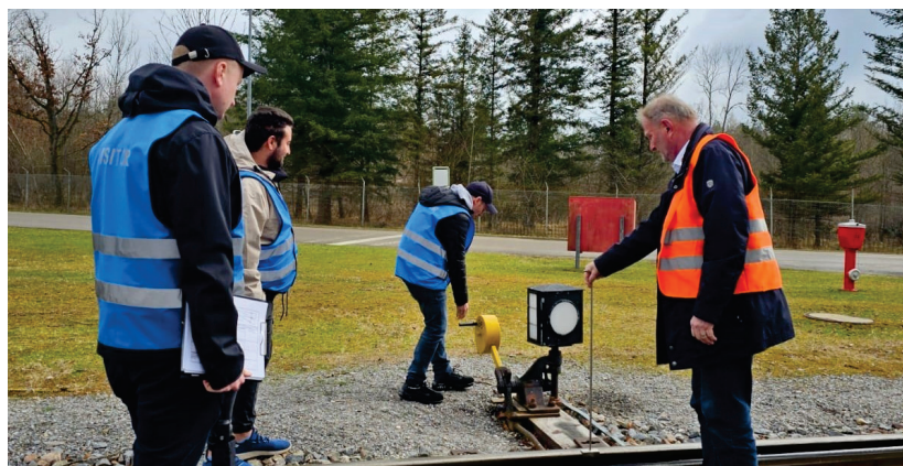
Auch die Prüfung einer handgestellten Weiche wird beim Vor-Ort-Termin gezeigt.
